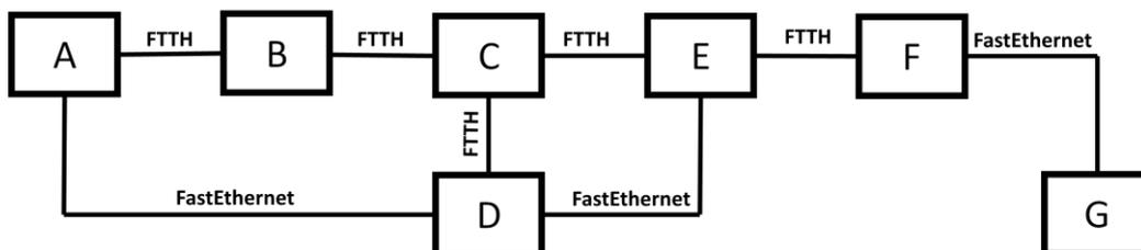
On rappelle que la bande passante des liaisons FTTH (fibre optique : Fiber To The Home) est de 10 Gbit/s et celle des liaisons FastEthernet de 100 Mbit/s.
